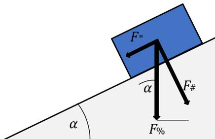
**Fig. B4** Inclined plane.
